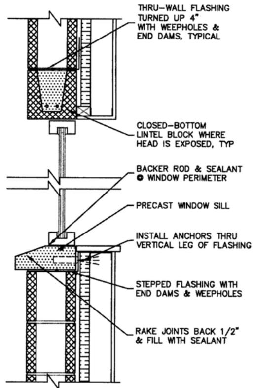
SILL & BOND BEAM FLASHING
